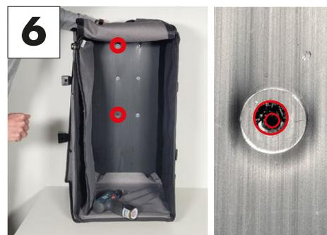
6 Installer la nouvelle poignée télescopique en commençant par visser deux vis avec rondelles. S'assurer du bon alignement des trous du sac avec ceux du carter de la poignée télescopique avant le vissage.
