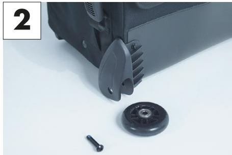
Retirer la roue usagée et prendre une nouvelle roue.
